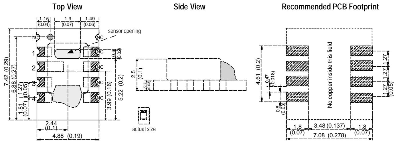
图 15 SHT1x 尺寸图和引脚尺寸 mm (inch)
