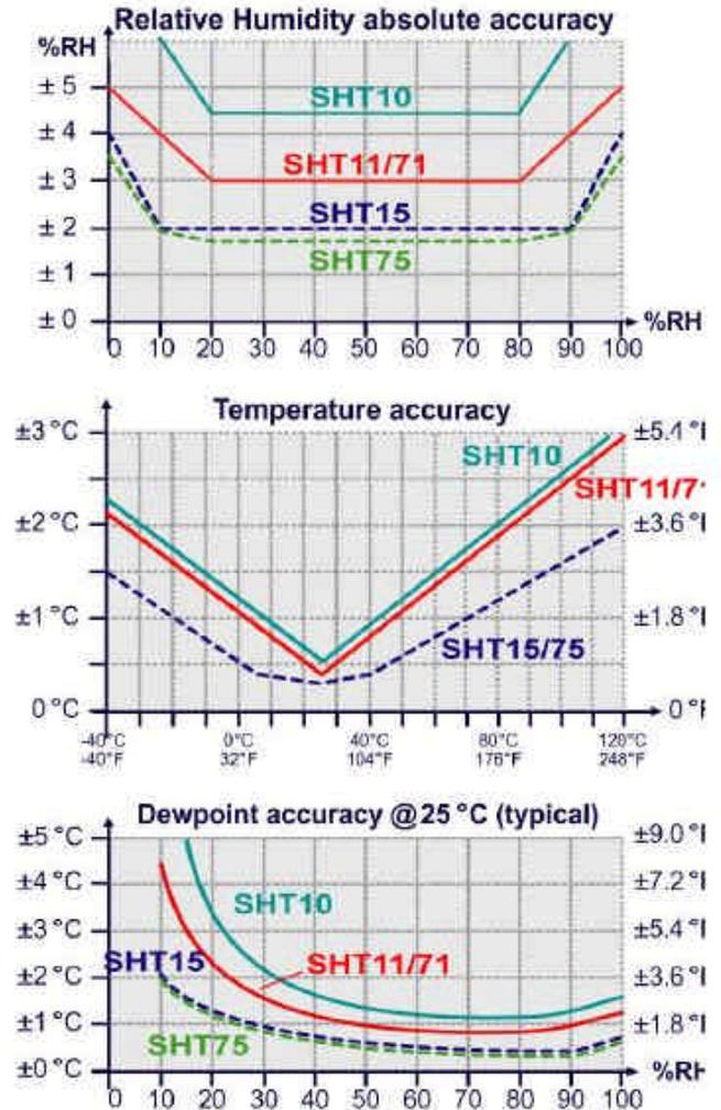
图 1 相对湿度、温度和露点的精度曲线
