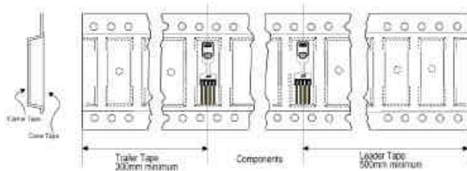
图 16 胶带结构和单片包装
