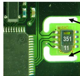
缝隙用以减少来自 PCB 的热传导
