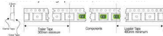
图 12 胶带结构和单片包装
