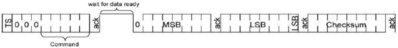
图 6 测量时序概览 (TS = 启动传输)
