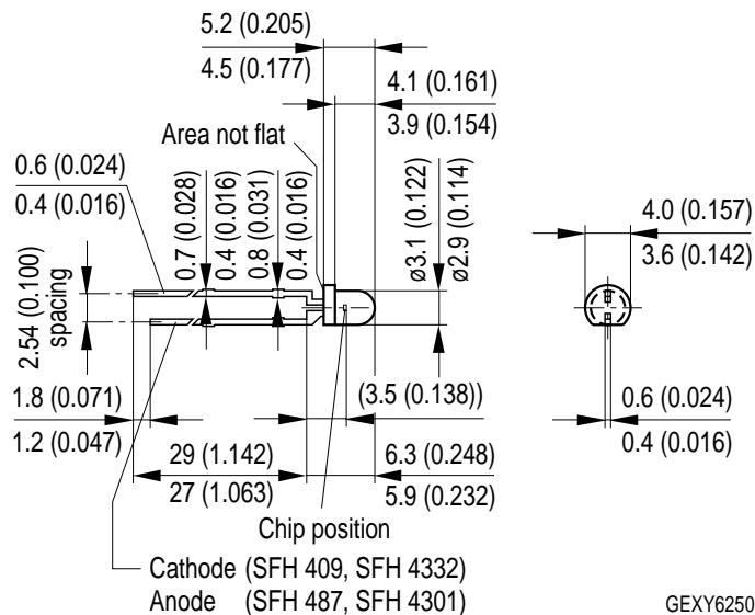
Maße werden wie folgt angegeben: mm (inch) / Dimensions are specified as follows: mm (inch).
