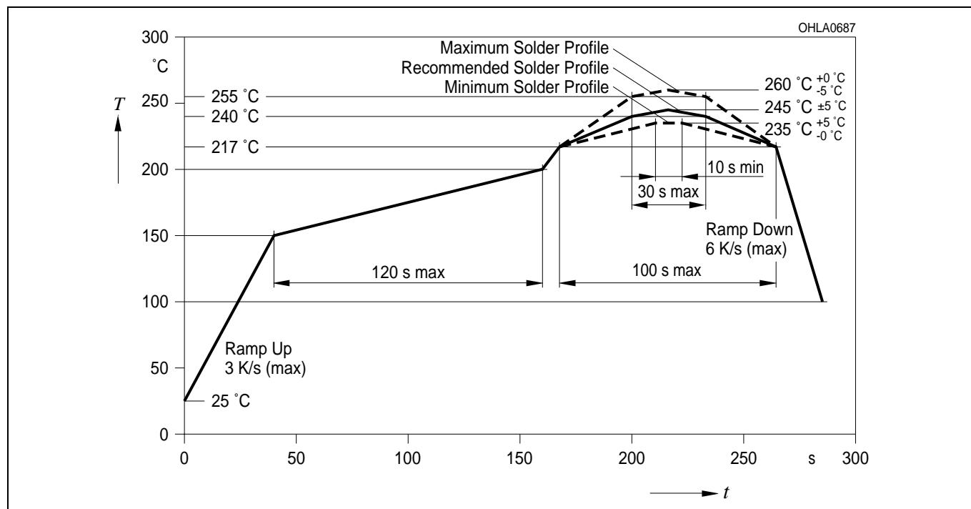
**Wellenlöten (TTW)****TTW Soldering**
