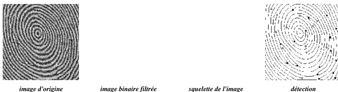
Figure I-8: Méthode classique d'extraction de la signature à partir d'un squelette binaire.
