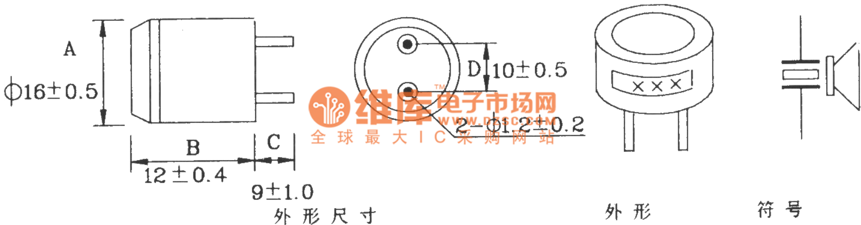
T/R-40-XX系列超声波传感器外形、尺寸及电路符号
