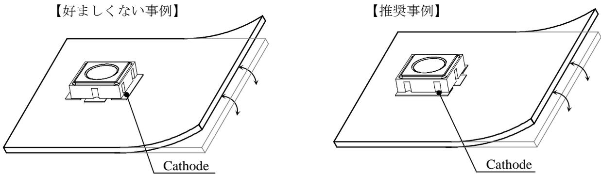
ストレスの作用する方向に対して横向きにLEDを配置してください。
